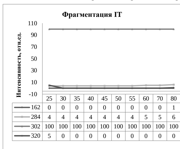
Рис.1 Зависимость интенсивности фрагмент-ионов в камере линейной ионной ловушки (гелий)
