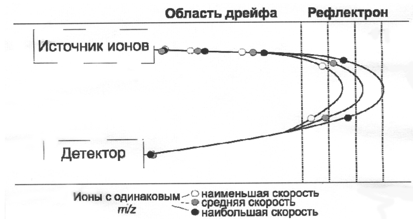
Рис. 2.1. Принципиальная схема масс-рефлектора.
