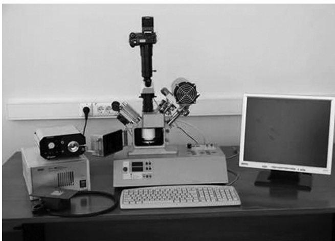
Рис. 1.11. Микроанализатор «Фокус-М» с рентгеновской линзой Кумахова.
