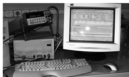
Рис. 4.8. Прецизионный кулонометр ПИК-200, разработанный в Институте геохимии и аналитической химии им. В.И. Вернадского АН СССР.
